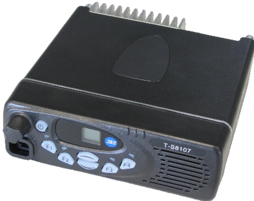
Als Option kann der SE-Teil auch mit einem einfachen Bediengerät ausgestattet werden. Der Typ - B kann immer dann eingesetzt werden wenn kein Platz für einen externen Zusatzlautsprecher ist oder die Sonderfunktionstasten (z.B. für die Sprachverschleierung) benötigt werden.
