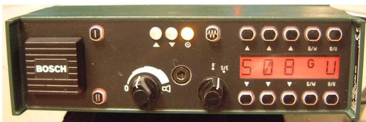
Die Bedienteile nach TR BOS FUG 8 verschiedenster Hersteller werden über einen Adapter an das SE-Teil angeschlossen (SEL, Bosch-Z, Motorola). Der Adapter, der einfach hinten auf den 37 poligen SUBD Stecker des Bediengerätes aufgesteckt wird, enthält die komplette Anpasselektronik und stellt durch eine dünne, lediglich zehnadrigte Leitung die Verbindung zum SE-Teil her.
