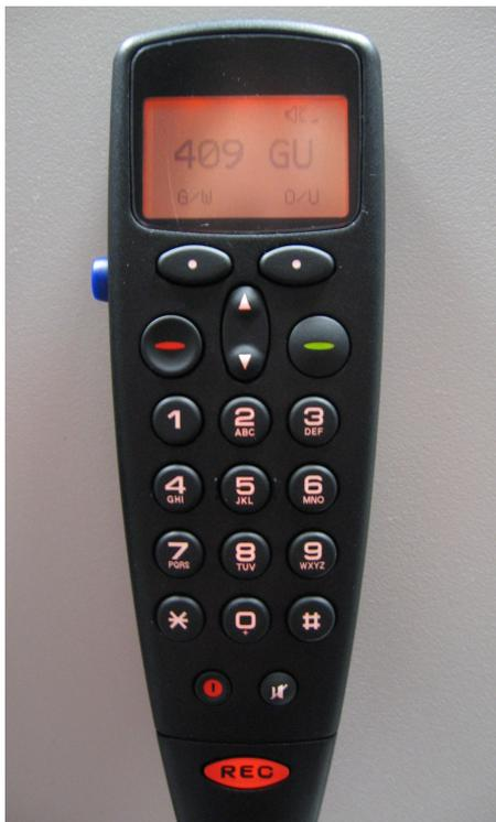
Neben den Standardfunktionen wie Einstellung von Kanal / Bandlage / Betriebsart sowie des FMS Systems ermöglicht der BHA mit seiner grafikfähigen Anzeige zusätzliche Funktionen
